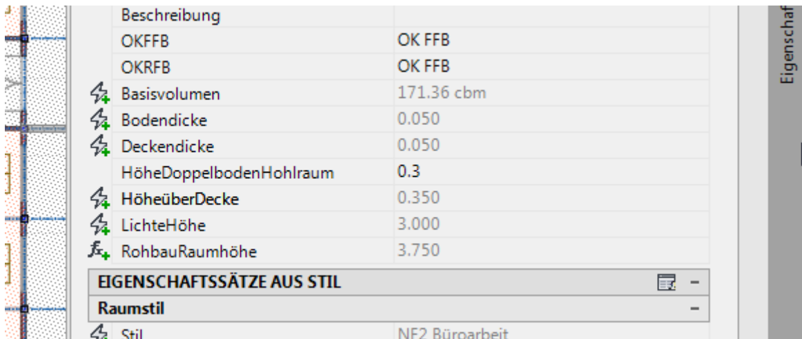
Abbildung 2.6-12: Fertige Eigenschaft Rohbau-Raumhöhe nach Übertrag Höhe Doppelboden Hohlraum
